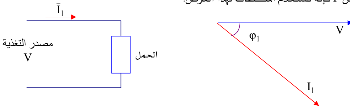
شكل (٢-١٣) الدائرة الكهربائية قبل توصيل المكثفات.
